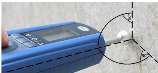
Abbildung 4-3 Messung möglichst senkrecht zur Messfläche
